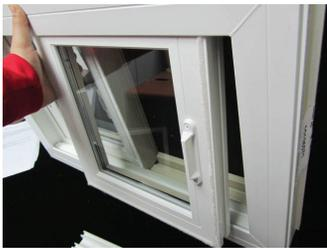
1. Inserte el borde superior del sash en el bolsillo del marco y inserte el borde inferior del sash sobre el marco. Tenga cuidado de no golpear hacia fuera los rodillos inferiores, inserte la faja en el carril inferior.
